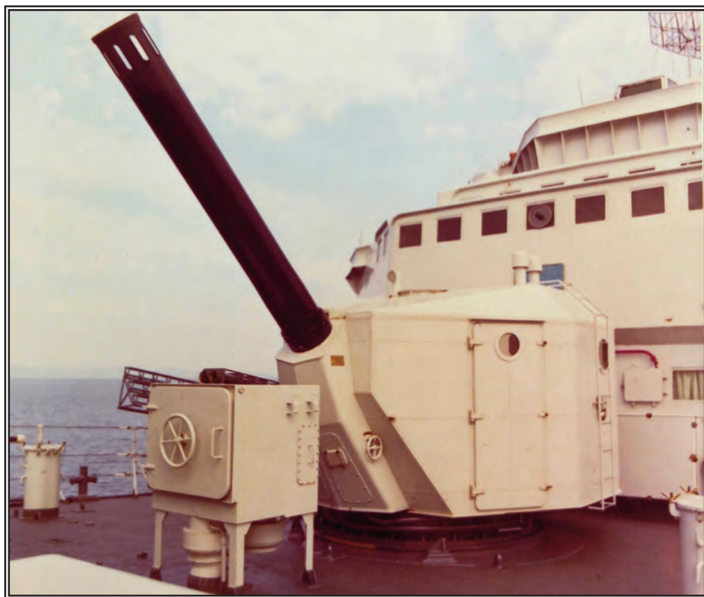
Il lanciatore di bombe antisommergibili Whitehead K 113 a canna singola (Fototeca dell'Ufficio Storico della Marina Militare, Roma)
